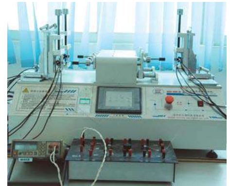
スイッチ / インレット・アウトレット 寿命試験機
